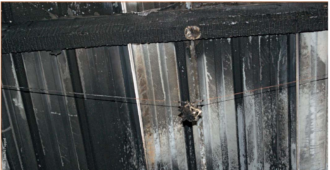
Abb. 1: Fragmente eines Brandmelders nach einem Brand
